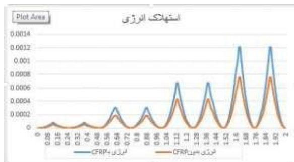
شکل (۴) نمودار میزان استهلاک انرژی بار جانبی وارد بر ستون
