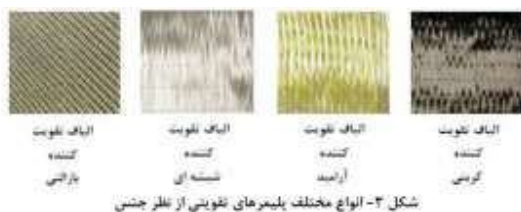
شکل ۳- انواع مختلف پلیمرهای تقویتی از نظر جنس
