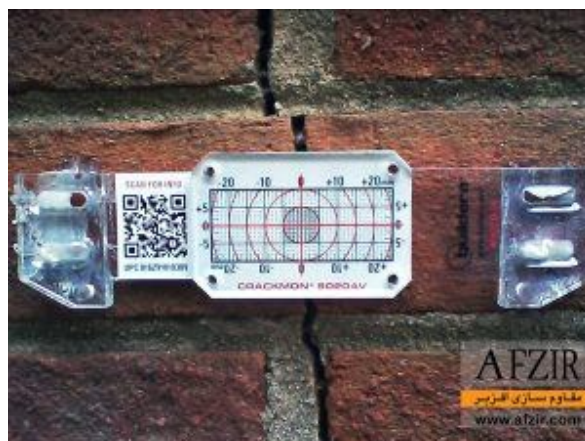
بررسی ترک به روش Plastic Tell Tale
